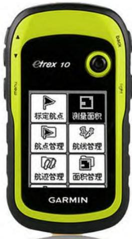
图 2 佳明高精度 GPS 面积测量仪
